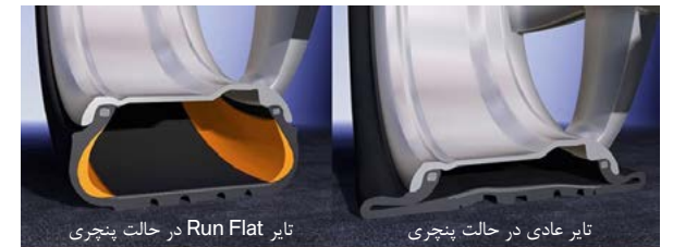
تایر عادی در حالت پنچری / تایر Run Flat در حالت پنچری
